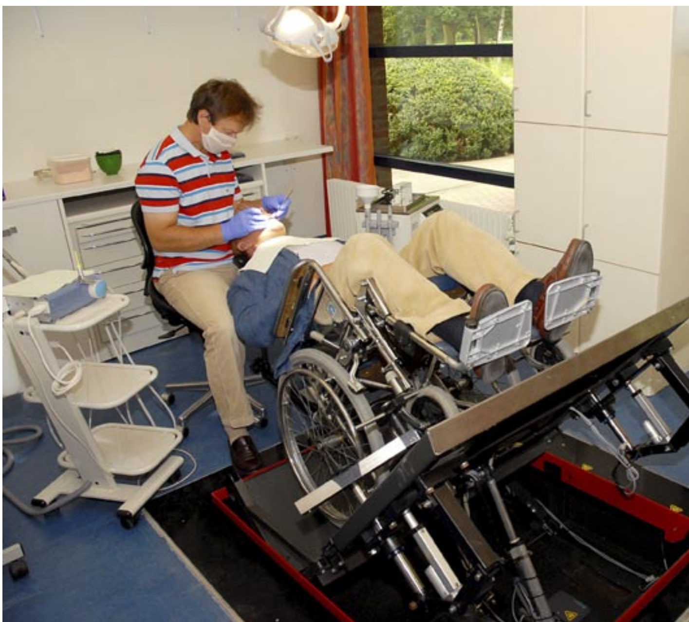
Tandarts F. Rooijackers in het Centrum voor Reuma en Revalidatie behandelt een patiënt van het Centrum met behulp van de Universele Rolstoel Manipulator.
